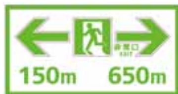
トンネル内誘導表示板B 660H×1260W
